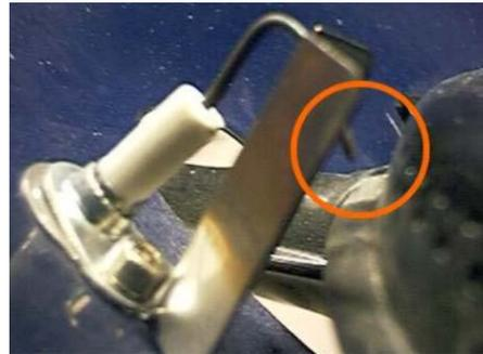
Biegen Sie die Zündelektrode so, dass deren Spitze unterhalb der Gasaustrittslöcher ist. Die Distanz zwischen Elektrode und Brenner darf nicht kleiner als 5mm und nicht grösser als 8mm sein. Biegen Sie die Elektrode langsam und vorsichtig. Bei gewaltsamem Vorgehen kann die Elektrode brechen.
