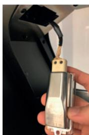
3. Lösen Sie die Sicherungsschrauben am Sockel und entfernen sie die Kabel.
