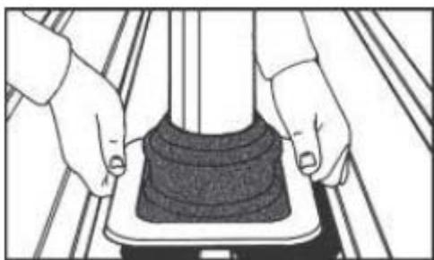
Schiebe die Dichtung das Rohr hinunter – du kannst Wasser als Gleitmittel verwenden, wenn nötig.
