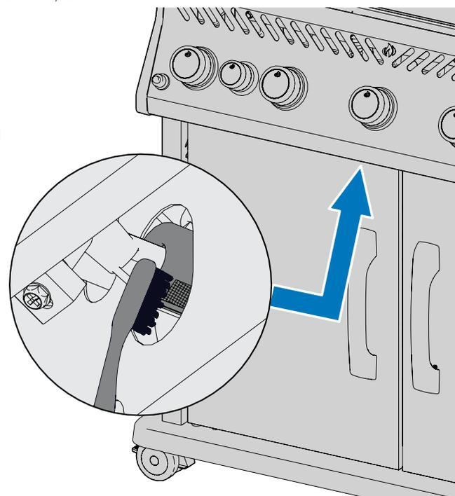
**ACHTUNG!** Es ist sehr wichtig, dass das Ventil/die Blende beim Wiedereinsetzen des Brenners nach der Reinigung und vor dem Anzünden des Grills in das Brennerrohr eingeführt wird, da es sonst zu Bränden oder Explosionen kommen kann.
