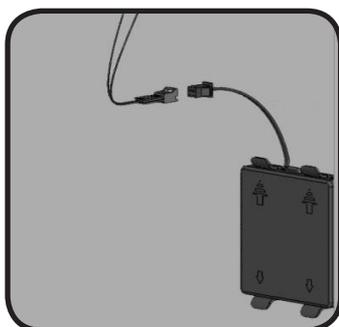
Batteriefachmodul (led-leuchten) im schrankinneren mit einem mindestabstand von 20 cm zur unterseite der auffangschale montieren, um das modul vor überhitzung zu schützen. Sicherstellen, dass kabel und module den Zugang zur auffangschale nicht behindern. Batterien wie abgebildet installieren. Das led-kabel (beleuchtung) unterhalb der bedienleiste mit dem kabel des batteriefachs verbinden. Sicherstellen, dass kabel nicht mit der grillunterseite in kontakt sind.
