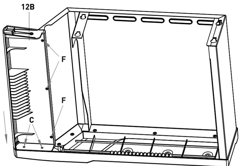
Drehen Sie die Schrauben 6 mm heraus und hängen Sie die Seitenablage ein (Aufbauschnitt 16).
