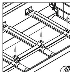
1. Schrauben lösen und Befestigung abheben.
