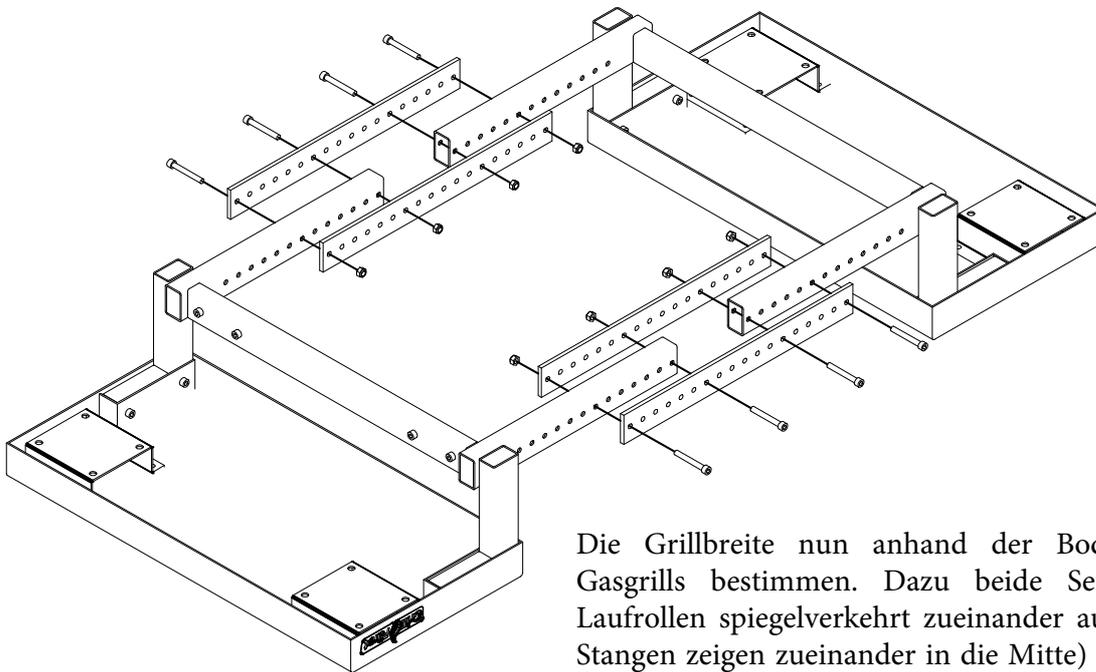
Die Grillbreite nun anhand der Bodenplatte des Gasgrills bestimmen. Dazu beide Seitenteile mit Laufrollen spiegelverkehrt zueinander aufstellen (Die Stangen zeigen zueinander in die Mitte) und dabei an der Bodenplatte orientieren.
