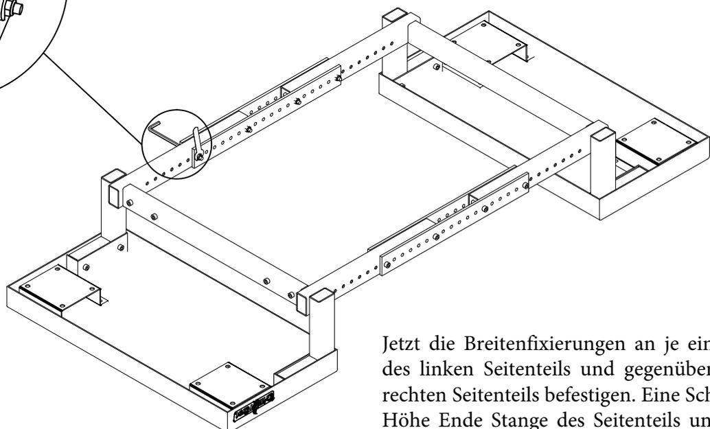
Jetzt die Breitenfixierungen an je einer Stange des linken Seitenteils und gegenüberliegenden rechten Seitenteils befestigen. Eine Schraube auf Höhe Ende Stange des Seitenteils und eine an das Ende der Fixierung. Hier besteht die letzte Möglichkeit die Breite zu kontrollieren.
