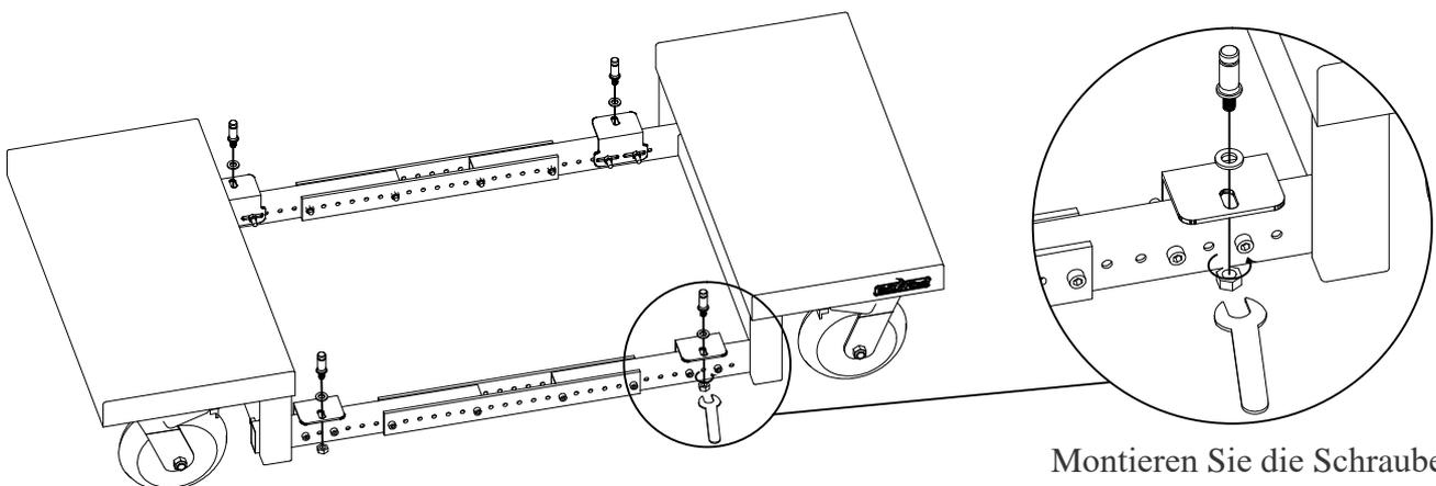
Montieren Sie die Schraube
