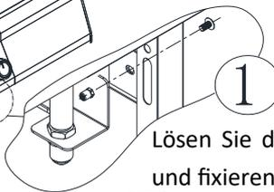
Lösen Sie den Gasschlauch hinter der Frontblende und fixieren Sie ihn am Unterschrank
