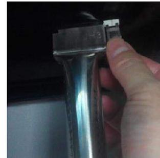
2. Neuen Brenner in die Öffnung stecken und im hinteren Bereich einhaken. Mit Halteclip wieder fixieren.
