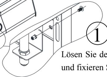
1 Lösen Sie den Gasschlauch hinter der Frontblende und fixieren Sie ihn am Unterschrank
