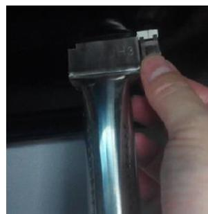
2. Neuen Brenner in die Öffnung stecken und im hinteren Bereich einhaken. Mit Halteclip wieder fixieren.
