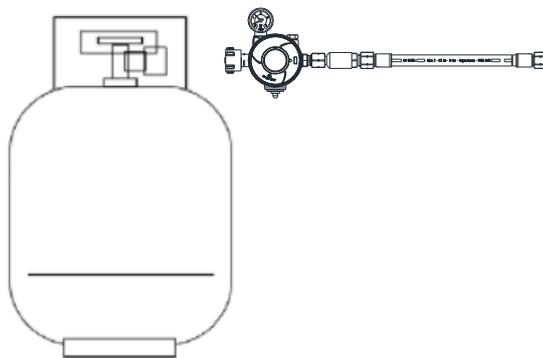
Montage Gasschlauch und Druckminderer
