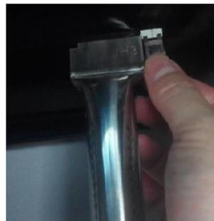
2. Neuen Brenner in die Öffnung stecken und im hinteren Bereich einhaken. Mit Haltclip wieder fixieren.
