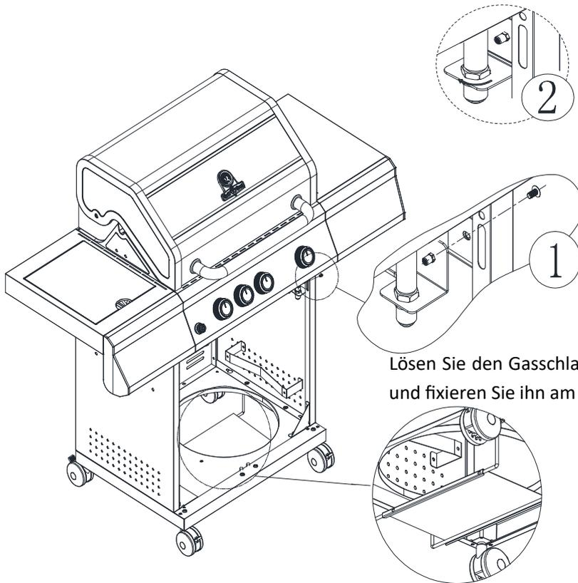
Lösen Sie den Gasschlauch hinter der Frontblende und fixieren Sie ihn am Unterschrank
