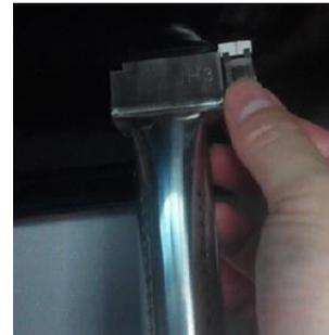
2. Neuen Brenner in die Öffnung stecken und im hinteren Bereich einhaken. Mit Haltclip wieder fixieren.
